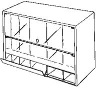
Qualitativ hochwertiges Gehäuse, weiß kunststoffurniert, staubdicht abgedeckt durch Plexiglasscheiben, grifftechnisch optimale Einteilung; zum Verschrauben zwischen den Profilen.
