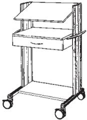
Fahrgestell mit Bodenplatte 300 mm tief, Rollen Ø 100 mm, 2 Feststellern. In der Neigung verstellbare Ablageplatte 450 mm tief mit Anti-Rutschkante, Schublade 100 mm hoch, Schubladenabdeckplatte 450 mm tief, Schubladeneinsatz mit variabler Einteilung. Schreibhöhe ca. 1040 mm.
