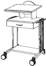
Fahrgestell mit Bodenplatte 300 mm tief, Rollen Ø 100 mm, 2 Feststellern, Schublade 100 mm hoch. Pultaufsatz bestehend aus: geneigter Schreibplatte, Maße: 600 x 450 mm (B x T) Utensilieneinsatz und Stifteköcher, Ablagefach, lichte Höhe (vorne): ca. 200 mm. Schreibhöhe: ca. 1030 mm
