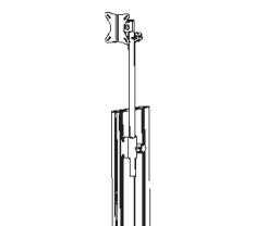
für Flachbildschirm (VESA-Standard 75 und 100 mm). Montage an höhenverstellbarer Stange seitlich am Profil oder an einer Quertraverse (Bitte Quertraverse separat bestellen).
