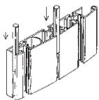
grau, für vordere und mittlere Nut des swingo®-Profils. Passend für alle Höhen.
