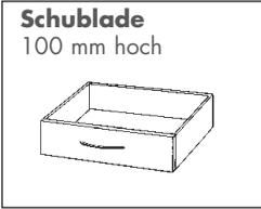
zur Montage unter einer Ablageplatte; mit schwebeleichter Kugel-Teleskop-Führung und Einrastmechanismus.
