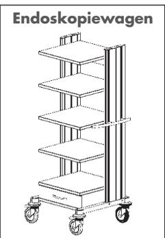
Fahrgestell mit 4 elektrisch leitfähigen Rollen Ø 125 mm, 2 Feststellern, 5 Ablageplatten 450 mm tief, Quertraverse, 1 Schublade 100 mm hoch.
