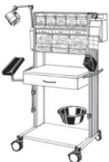
Fahrgestell mit Rollen Ø 100 mm, 2 Feststellern, Trägerprofilsatz in Standardhöhe 1218 mm. Schublade 100 mm hoch, Schubladeneinsatz mit variabler Einteilung, Injektionsset PicBox® und KOMBI-Set, Kanülensammler Schluckfix (Set mit 20 Boxen), Abwurf mit Schale aus Chromnickelstahl, Armauflage. Die Leuchte ist in der Grundzusammenstellung nicht enthalten.
