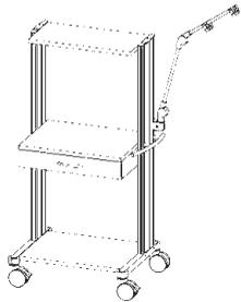
Fahrgestell mit Rollen Ø 100 mm, 2 Feststellern, Trägerprofilsatz in Standardhöhe 1218 mm. Schublade 100 mm hoch, obere Platte 300 mm tief, Kabelhalter Ref.-Nr. 13926.
