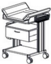
Fahrgestell mit Rollen Ø 100 mm, 2 Feststellern, Trägerprofilsatz in Standardhöhe 645 mm Gepolsterte Wickelauflage (wechselnde Dekore), Ablageplatte für Zubehör, Schublade 200 mm hoch, rechts Ablagekorb für Creme oder Puder, links 1 Abfallsammler "tomo".
